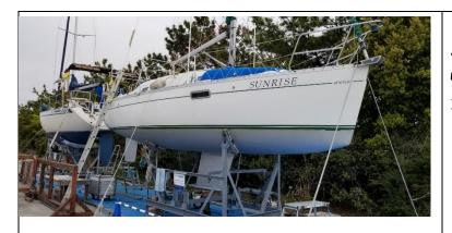
エアサンダーで成形した後、プライマー塗装してから船底塗料を2回塗りして仕上がります! 左写真はプライマー塗装・・・
